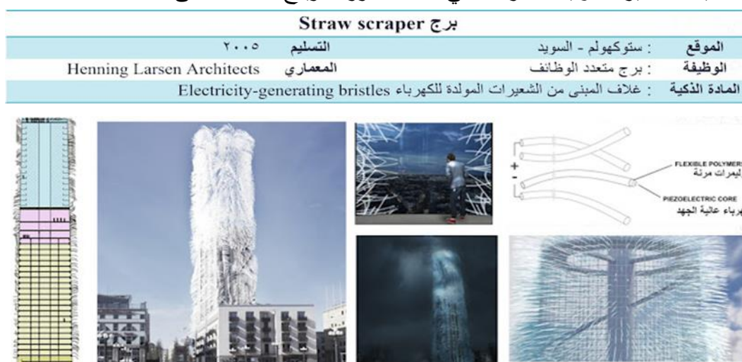
شكل (٤) يوضح غلاف مبنى Straw scraper يستخدم الخلايا الكهربية الذكية لتوليد الطاقة من الرياح
