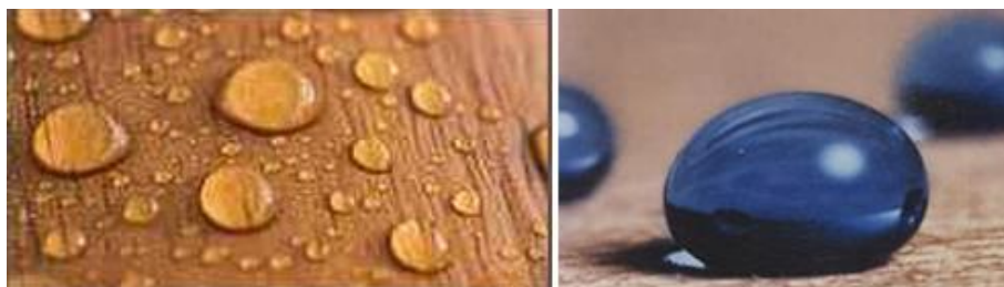
شكل (٧) يوضح سطح الخشب المعالج بطبقة من طلاء النانو الطارد للمياه
